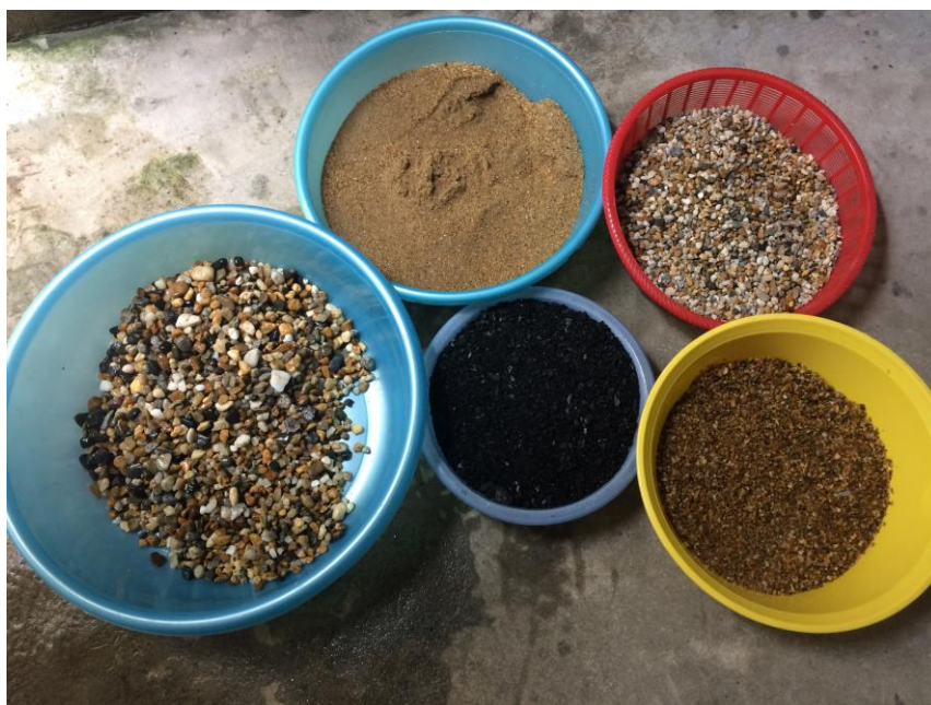
Hình 08. Vật liệu lọc sử dụng để làm mô hình xử lý chất hữu cơ trong nước
