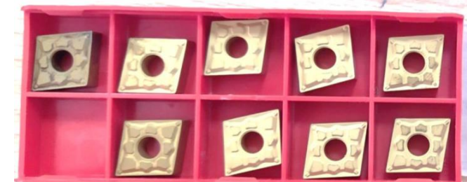
Hình 3.3. Phần cắt của dao dùng để gia công mẫu thí nghiệm
