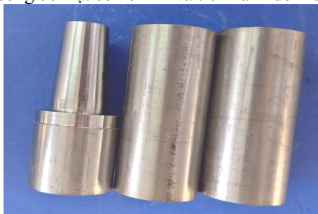
Hình 3.5. Hình ảnh phôi thép SUS304 trước và sau khi gia công bề mặt côn chính để kiểm tra độ nhám
