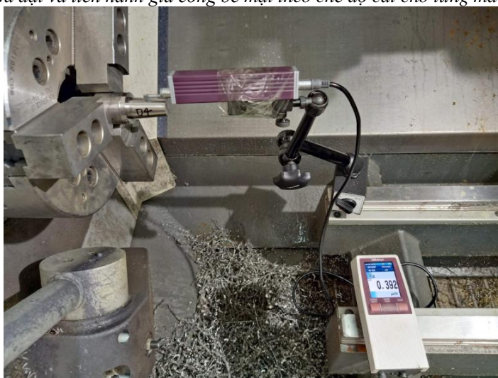
Hình 3.7. Hình ảnh quá trình đo kiểm tra độ nhám trực tiếp cho từng mẫu thí nghiệm bằng máy đo độ nhám cầm tay sau khi gia công xong
