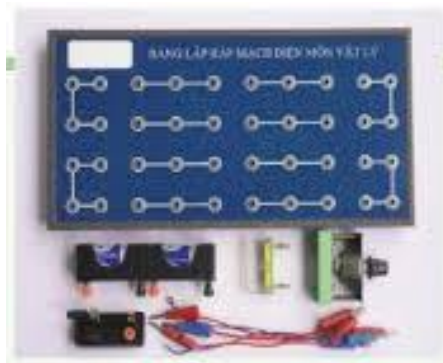
Hình 22.2. Dụng cụ thí nghiệm tìm hiểu tác dụng phát sáng của dòng điện
