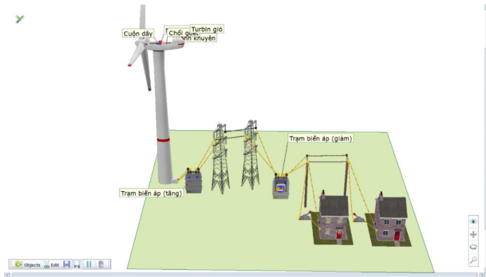
Hình 2.16. Mô hình thí nghiệm cảm ứng điện từ và nguyên tắc tạo ra dòng điện xoay chiều
